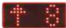
Табло индикации ТИМ2 - на базе матричных индикаторов. Может оснащаться голосовым сообщением номера этажа и перегрузки.
