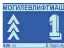
Табло ТИГ - монохромный ЖКИ с вариантами голосового информирования по желанию заказчика. Отображает текущее время, температуру, грузоподъемность, номер этажа, направление движения, сообщение о перегрузке и другую информацию.
